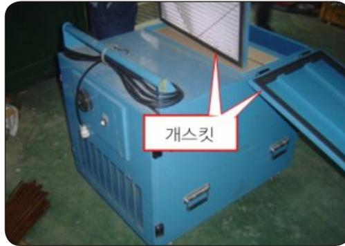
[그림 4-3] 공기누설 방지를 위한 개스킷 설치 예
