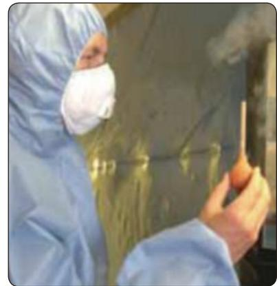
[그림 7-8] 발연관을 이용한 밀폐 적정유무 확인방법
