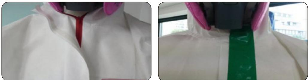
[그림 3-4] 지퍼덮개(좌) 및 지퍼부분 테이핑 처리(우) 예
