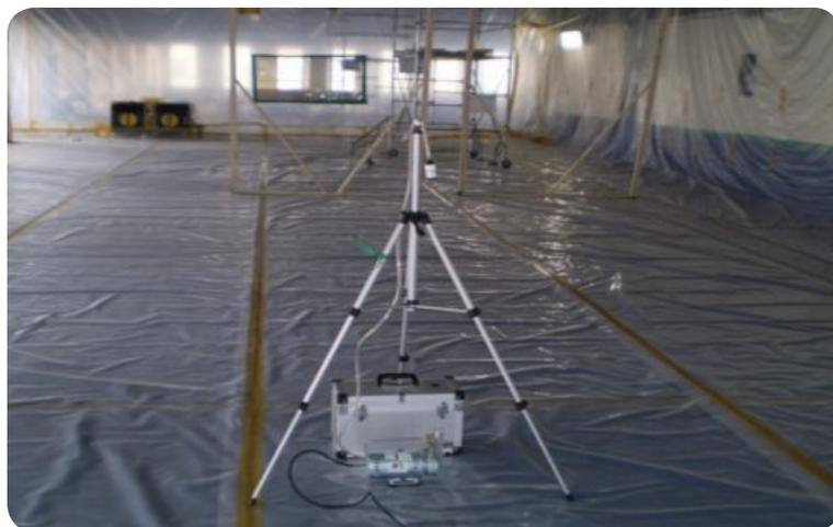
[그림 11-2] 석면농도 측정 모습
