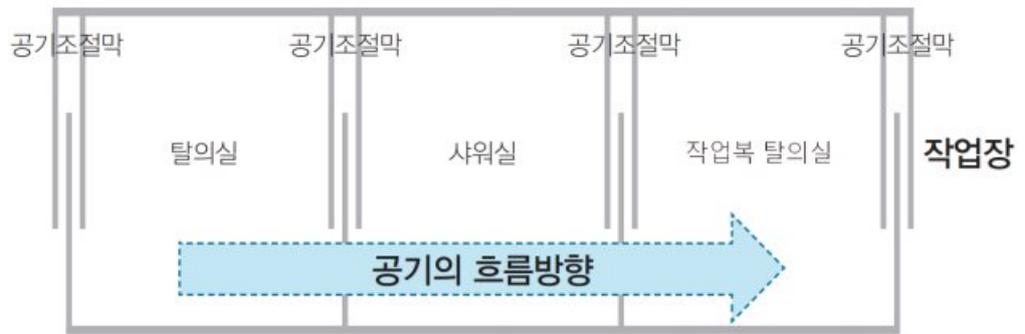
[그림 5-8] Z-LOCK의 설치 방법
