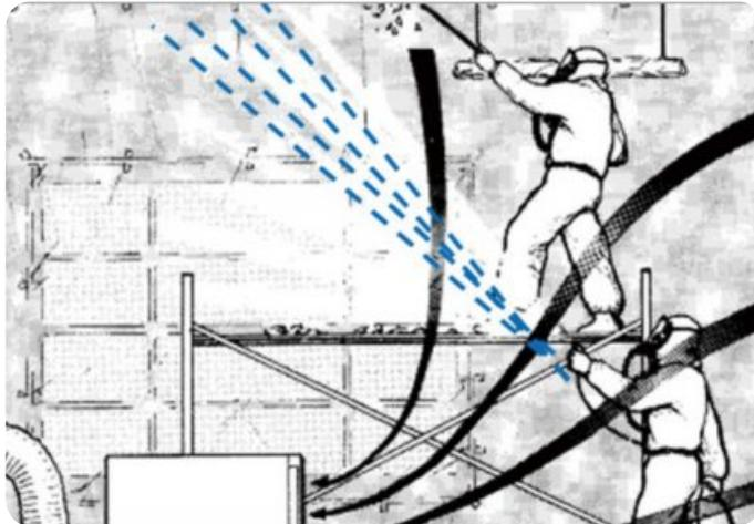
[그림 9-4] 뿔철재 제거시 습식작업 방법 예시
