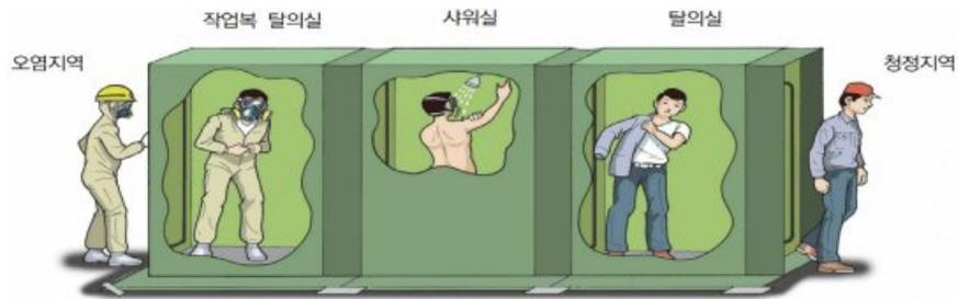
[그림 5-4] 위생설비 설치 및 사용
