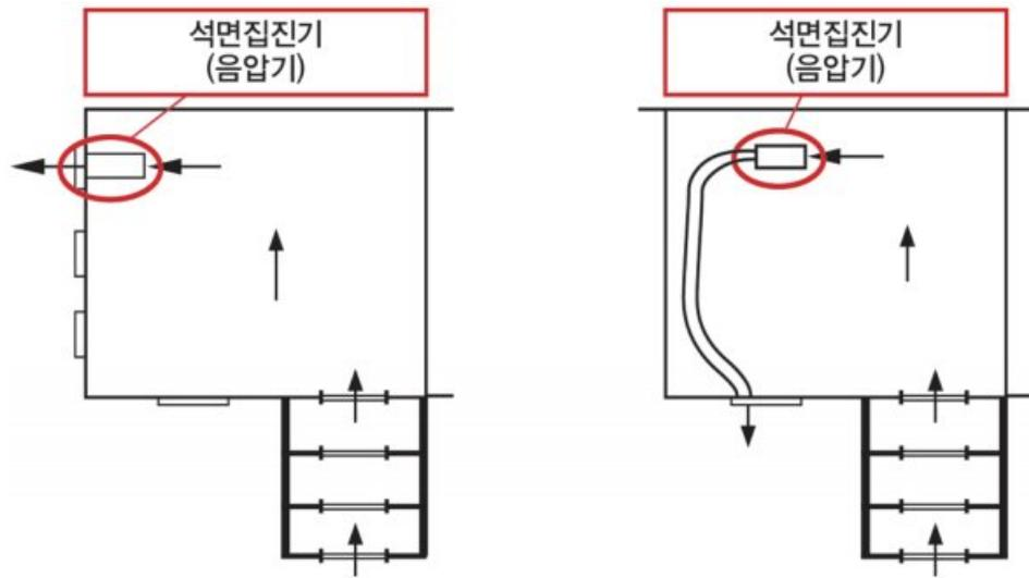
[그림 8-1] 밀폐작업장 내부 음압기 설치 예시
