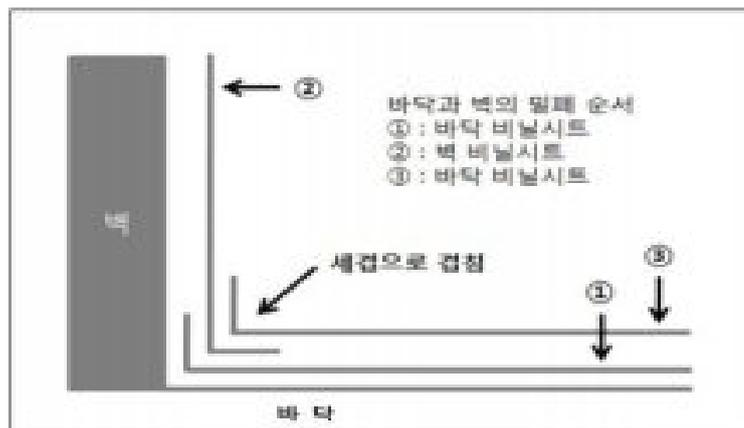
[그림 7-1] 비닐시트를 이용한 바닥과 벽의 밀폐순서
