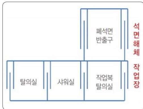
[그림 10-6] 석면폐기물 반출구 설치도면 예시
