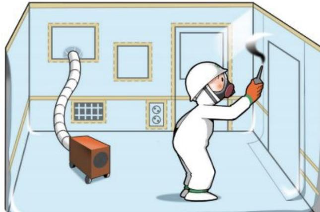
> 위생설비는 작업장의 밀폐 등 모든 준비가 끝난 후 배기장치를 가동시키고 발연관(smoke test tube)을 이용하여 비닐의 이음새 부분이나 접착부분 등에 공기가 새는 것을 확인합니다.
